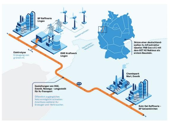
Bildunterschrift: Geplantes Wasserstoffnetz verbindet mit einer Länge von rund 130 Kilometern die Erzeugung von grünem H2 mit industriellen Abnehmern in Niedersachsen und NRW.
